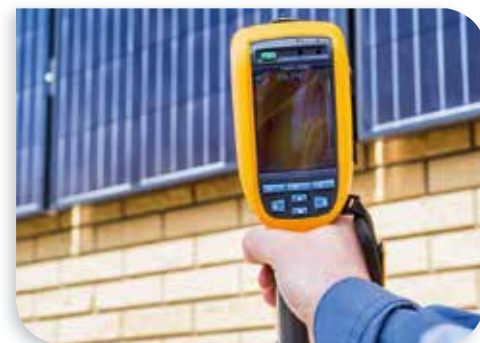
Bei einer Photovoltaik-Thermografie werden Schwachstellen farblich dargestellt.
